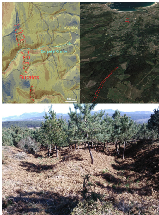
FIGURA 5. Enriba á dereita, minas galaico-romanas no Urgal cos labores dos Buracos dos Mouros en primeiro plano. Enriba á esquerda, mapa de pendentes da zona dos regatos da Gata e o Estripeiral Grande coa posición das cavadas e a zona de acumulación de refugallos, augas abaixo. Debaixo, fotografía dos foxos de dirección N70E segundo a traza dos filóns auríferos ao sur do Estripeiral Grande.
