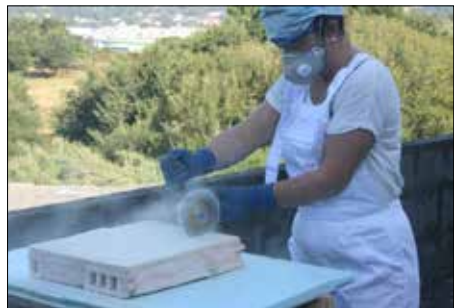
B. Realización do corte do morteiro sobrante.
