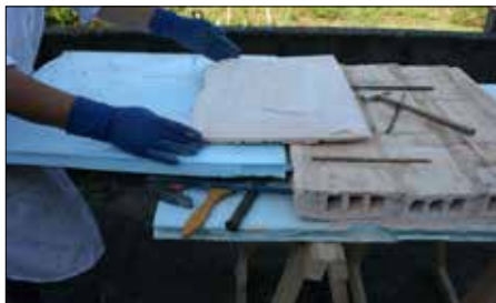
C. Retirada do enlucido do ladrillo por medios manuais.
