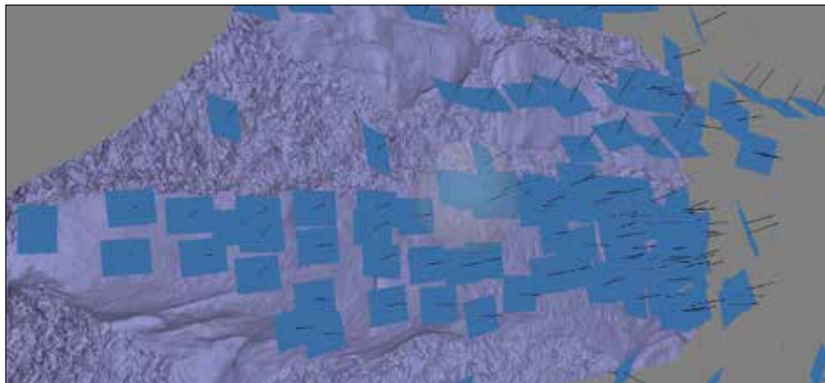
Modelo 3D e posición das cámaras dun levantamento fotogramétrico realizado mediante a técnica Structure from Motion (SfM) en Photoscan.
